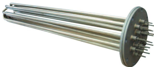
PS. 46 Resistenza tubolare scalda liquidi a più elementi saldati su flangia
