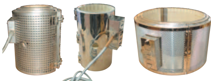
PS. 79 Resistenza a collare in ceramica con terminali protetti e foro TC a richiesta mantello coibentato per risparmio energetico a richiesta rete protezione antinfortunistica
