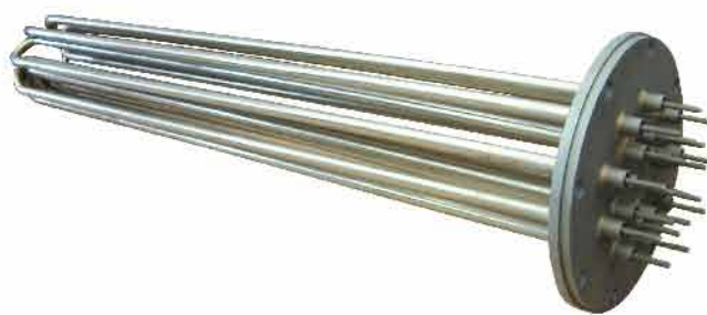
PS. 46 Resistenza tubolare scalda liquidi a più elementi saldati su flangia
