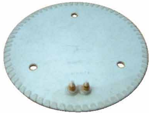
PS. 36 Resistenza circolare piatta con terminali a vite e fori fissaggio
