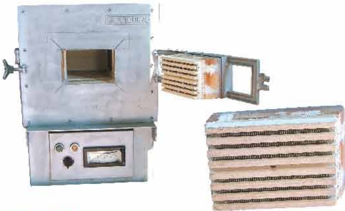
PS. 67 Resistenza per forni elettrici
