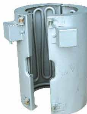
PS. 76 Resistenza a collare coibentata con serpentina tubolare corazzata riscaldante
